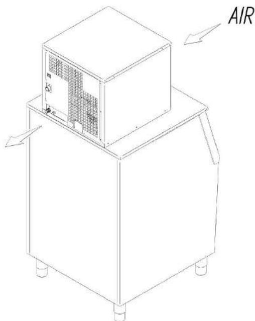
Per le unità modulari occorre tenere conto della posizione in cui il flusso d'aria deve fluire nella parte posteriore. Non posizionare oggetti dietro o davanti alla griglia anteriore.
