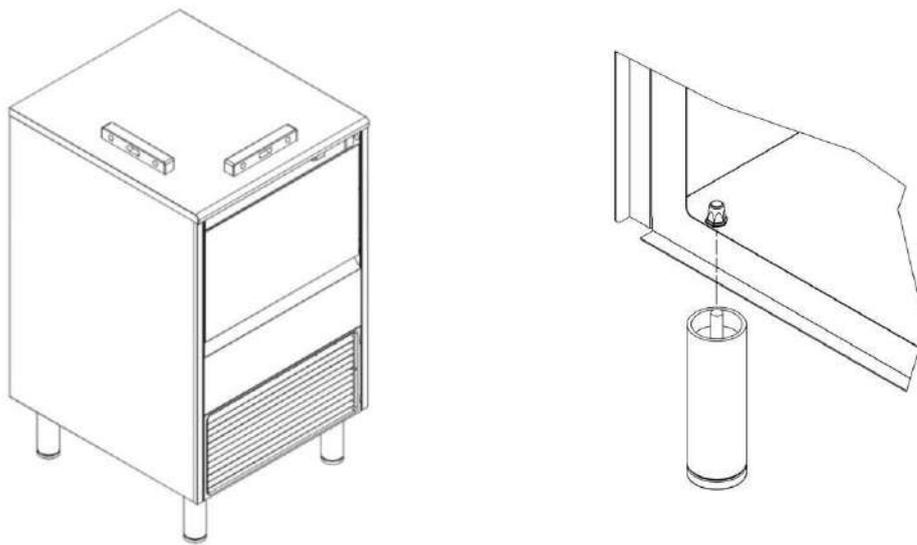
Nelle macchine modulari è necessario livellarlo regolando le gambe del silo.
