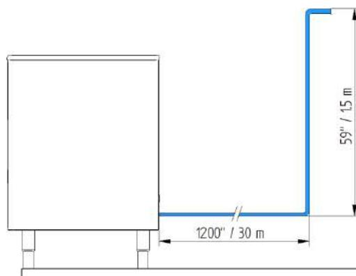
Se il tubo di scarico viene posizionato male, la pompa potrebbe non essere in grado di evacuare l'acqua, poiché la portata della pompa potrebbe essere influenzata dall'esistenza di aria immagazzinata all'interno del circuito.
