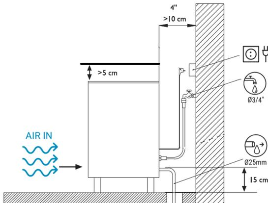
Des sorties d'air/renouvellements d'air doivent être prévues entre l'arrière de la machine et le mur.
