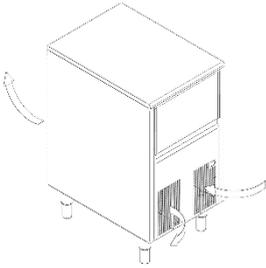
**TOURNER LES PIEDS DE NIVELLEMENT A LA BASE DE L'APPAREIL AFIN DE REGULER LE HAUTEUR POUR QUE L'APPAREIL SOIT PARFITEMENT A NIVEAU.**
