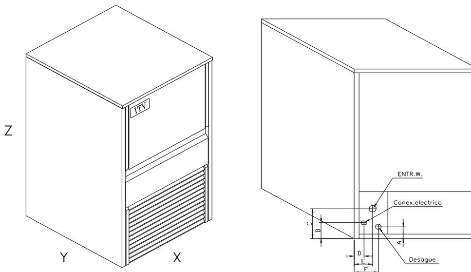
La cota z es la mínima altura de la máquina. Con las patas suplementarias esta altura se incrementa en 80 mm. Las cotas en mm.
