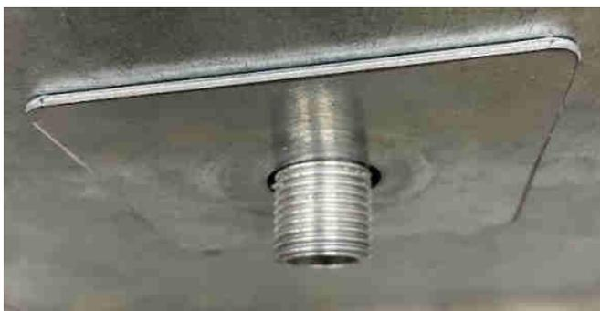
**ÉTAPE 7 :** Vissez le TUYAU MIXTE RÉDUIT au couvercle de vidange qui dépasse sous le silo. Le renfort se trouve juste au-dessus.
