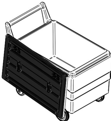
Con il coperchio aperto, posizionare il carrello sotto il contenitore del ghiaccio. Controllare che il carrello sia spinto fino in fondo. Le ruote anteriori devono toccare un tubo, come mostrato in figura.
