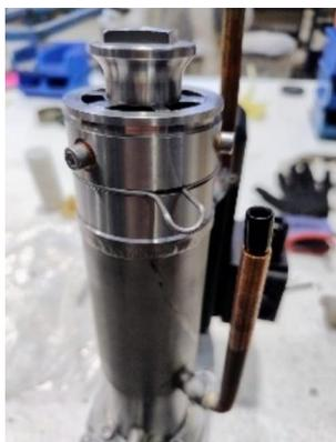
14. Posizionare l'ugello di uscita del ghiaccio e l'isolamento. Unire l'isolamento.
