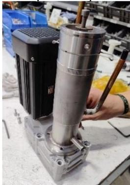
6. Posizionare le rondelle e le viti senza stringere per fissare l'evaporatore al motoriduttore.
