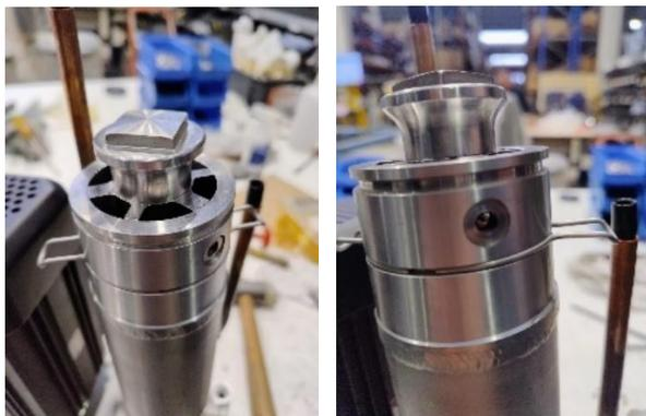
13. Posizionare le rondelle e le viti per fissare il montaggio dell'estrusore.
