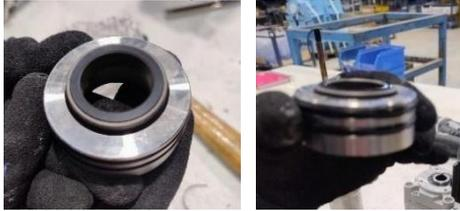
3. Applicare il lubrificante anche nell'evaporatore e inserire in esso l'anello-reten. Assicurarsi che il perno entra nel suo posto.
