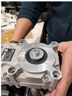
10. Posizionare l'anello di fissaggio e l'O-ring sull'evaporatore.
