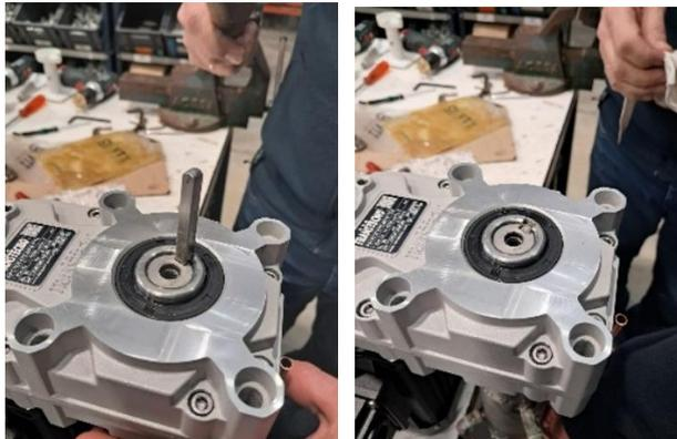
9. Posizionare la rondella e la vite nella parte inferiore del motoriduttore.
