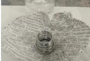
Lubrificare il mandrino e montare la guarnizione meccanica precedentemente pulita, avvitando in modo che entri meglio. Inserire fino a quando la molla tocca la parte del filo del mandrino.
