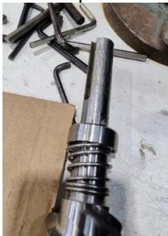
5. Inserire il mandrino nell'evaporatore, e mettere la rondella e la vite come aiuto sulla parte superiore.
