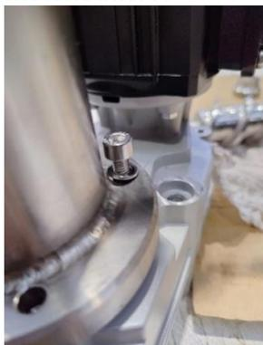
7. Posizionare il tubo di scarico nella fessura inferiore dell'evaporatore e serrare le viti. Assicurarsi che il tubo sia fissato in posizione.
