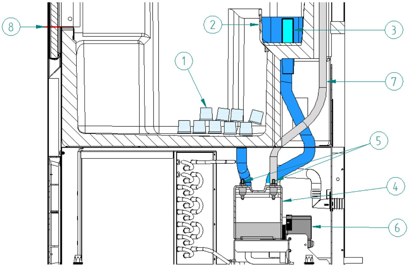
Il sistema ha un modo per evacuare l'acqua all'interno del serbatoio dell'acqua in modo manuale. C'è un tappo (#2) in uno dei tubi di plastica, ritirando questo tappo, è possibile evacuare tutta l'acqua.
